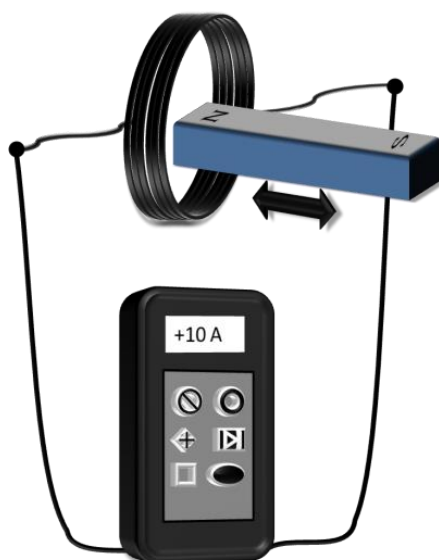
Εικόνα 7: Απεικόνιση της πειραματικής διάταξης μίας σύγχρονης παραλλαγής του πειράματος του Faraday
