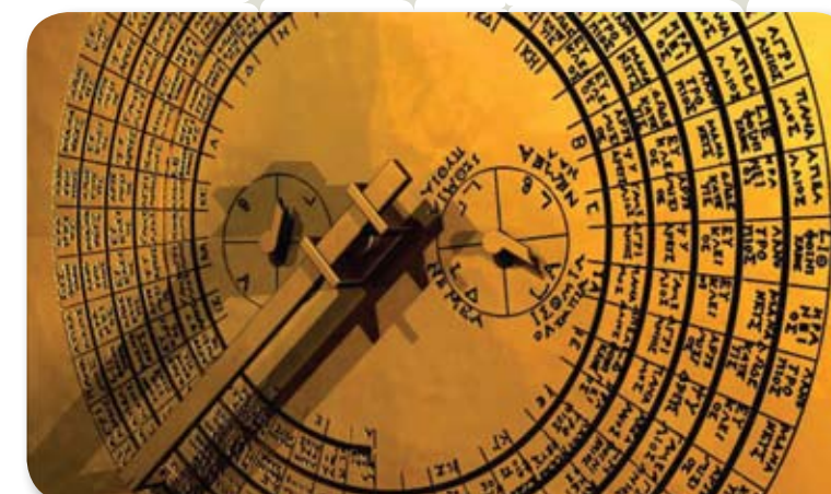
Ψηφιακή ανακατασκευή του ημερολογιακού δείκτη με βάση τη περίοδο του Μέτωνα. Ο μικρός δείκτης στο κέντρο και δεξιά προσδιόριζε πότε θα γίνουν οι Ολυμπιακοί αγώνες (© 2008 Tony Freeth / Antikythera Mechanism Research Project).
