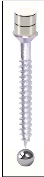
Εικόνα 24. Με τη βοήθεια ενός μαγνήτη νεοδυμίου και μιας βίδας να αναρτούμε την μεταλλική σφαίρα.
