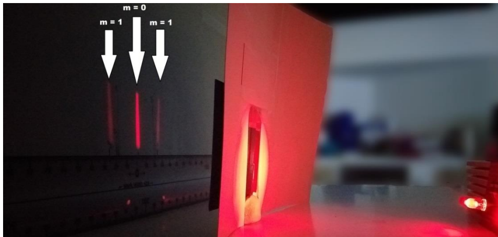
Εικόνα 47. Οι κροσσοί συμβολής που προκύπτουν από κόκκινο LED.
