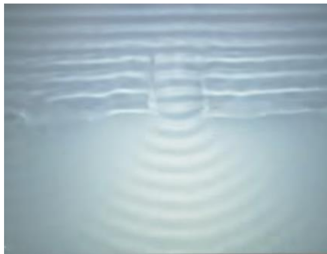
Εικόνα 18. Παραγωγή σφαιρικών κυμάτων από την περίθλαση επίπεδων κυμάτων σε μονή σχισμή.
