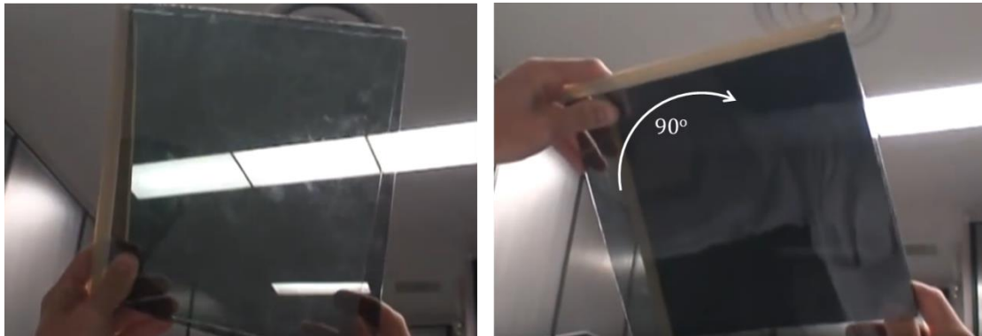
Εικόνα. Η πόλωση του ορατού φωτός με χρήση πολωτικών φίλτρων.
