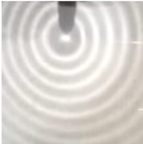
Εικόνα 15. Σφαιρικά κύματα τα οποία δημιουργούνται στην επιφάνεια του νερού από την ταλάντωση του μονού ελάσματος.
