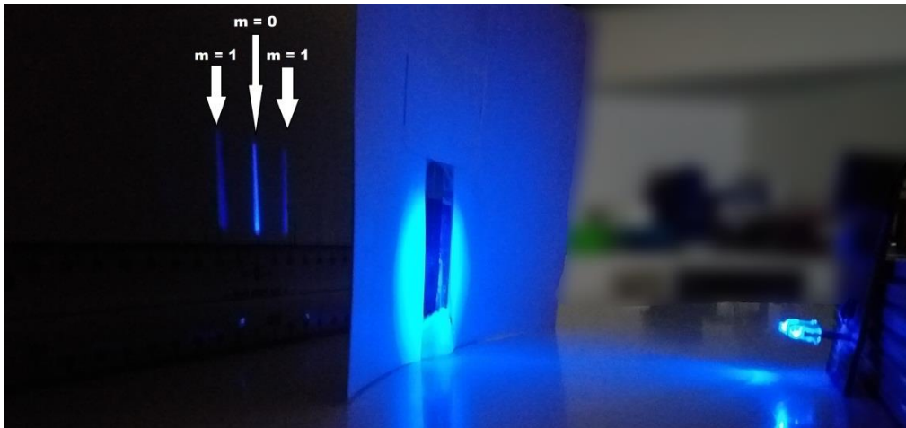
Εικόνα 49. Οι κροσσοί συμβολής που προκύπτουν από μπλε LED.
