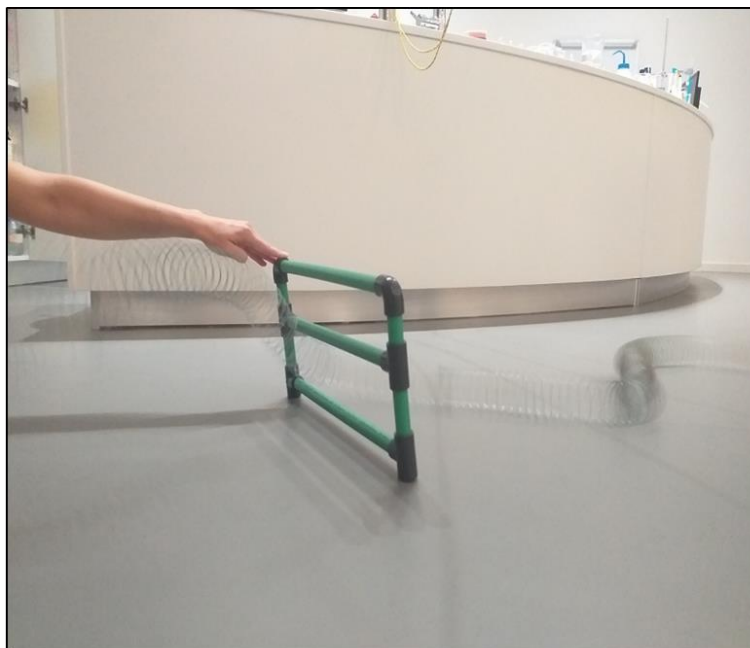
Εικόνα 27. Πάνω: Πειραματική διάταξη επίδειξης της πόλωσης του φωτός μέσω μηχανικού ανάλογου.
