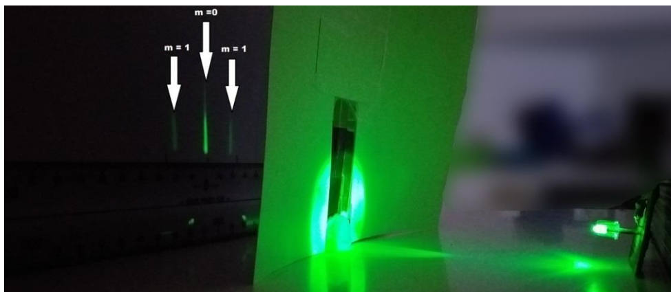
Εικόνα 48. Οι κροσσοί συμβολής που προκύπτουν από πράσινο LED.
