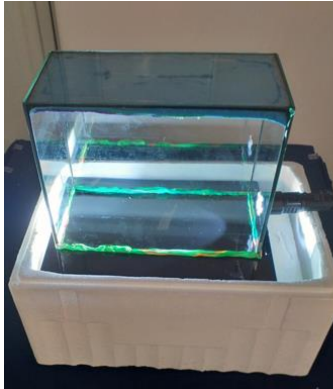
Εικόνα 13. Τελική τοποθέτηση του θαλάμου νεφών μαζί με το φακό
