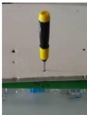
Εικόνα 8. Πώς να ανοίξετε μία τρύπα χρησιμοποιώντας ένα κατσαβίδι.
