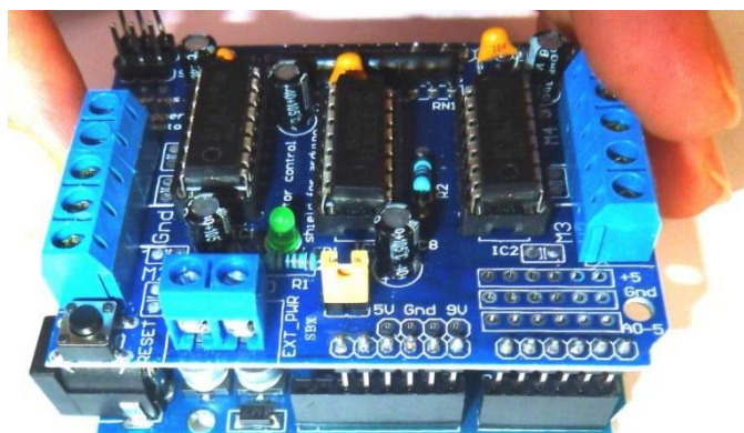
Εικόνα 16: Τοποθετήστε την πλακέτα οδήγησης του κινητήρα στον μικροελεγκτή
